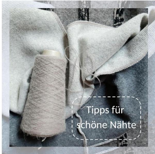
Zum Versäubern der Kanten, könntest Du in Deiner Overlock dünne Konenwolle als Unterfaden einfädeln - genauer gesagt musst Du den linken Unterfaden gegen Wolle ersetzen - siehe „[Tipps für schöne Nähte](#)“
